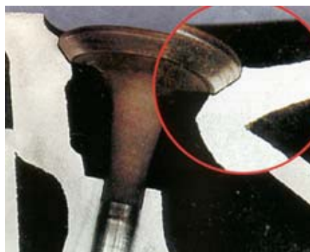
Uitlaatklep zonder Flashlube klepsmering
